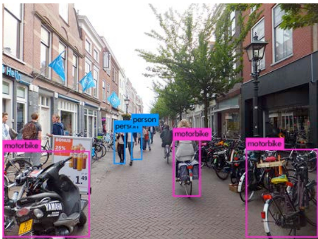
Afbeelding 2: We trainen een Convolutional Neural Network die gebieden afbakt waarin herkende objecten zich bevinden.
