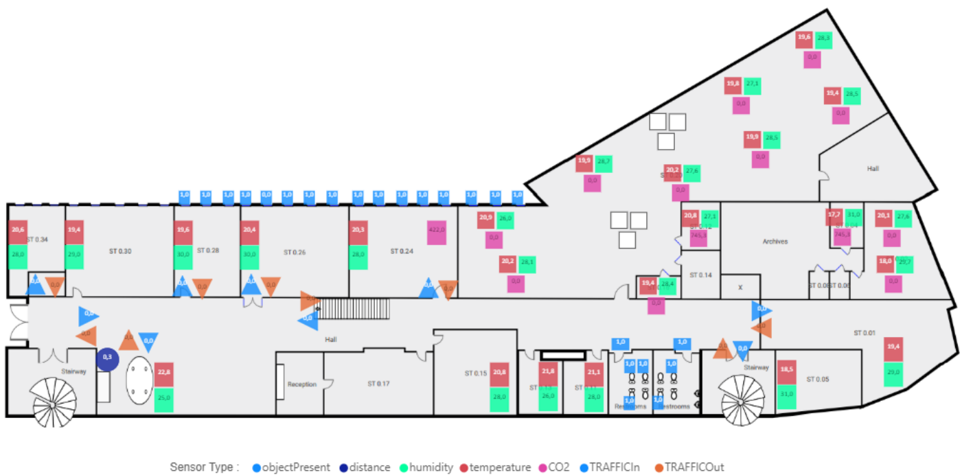
Figuur 1. Locaties van de verschillende sensoren in het living lab
