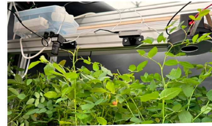
Figuur2: De low-cost multispectrale camera (rechter camera) naast twee andere camera's, gemonteerd op een wagen die over planten rijdt om geautomatiseerd ziektes te detecteren.
